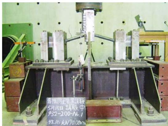
図2 両端固定繰返し曲げ試験機
