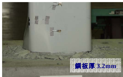
写真-1 NO1 終局状況
