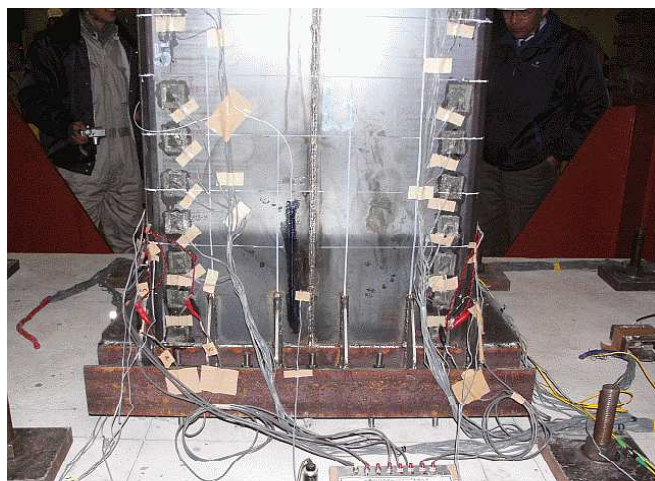
写真-2 鋼板変形状況(鷹取波 70%加振後)
