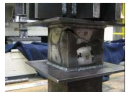
写真 - 2 従来鋼のき裂状況
