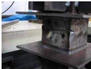
写真 - 1 耐疲労鋼のき裂状況
