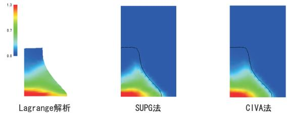
図-4  $80\mu(\text{sec})$  後の変形形状及び、相当塑性ひずみ分布
