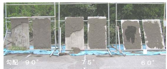
写真1 付着性試験状況(1年後)
