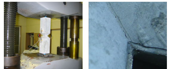
図5 ひび割れ誘発試験の状況
