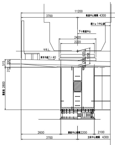
図1. 試設計対象断面図（中間支点部）
