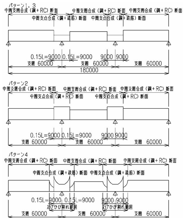
図2. 試設計対象橋梁と仮定剛度（合成後荷重）
