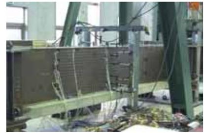
図3 供試体と荷重装置
