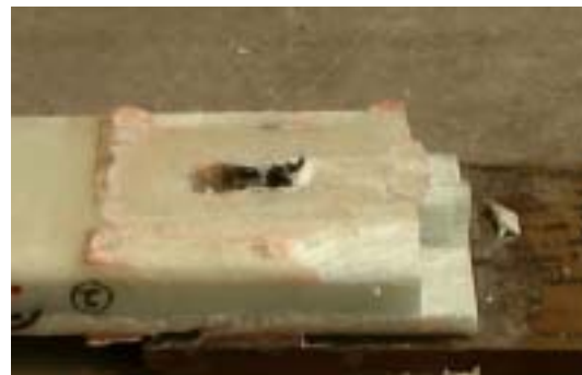
図 - 3 (b) 試験体の破壊状況 (HYSOL 併用)
