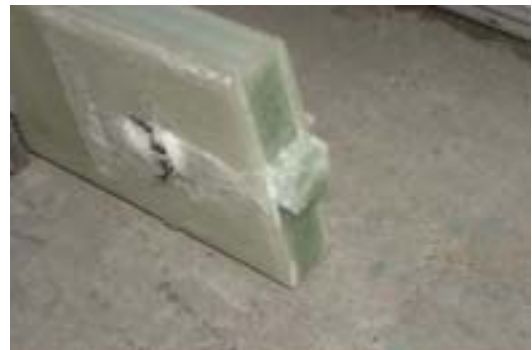
図 - 3 (a) 試験体の破壊状況 (EP-007 併用)
