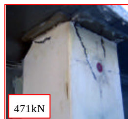
Case B 垂直補剛材の圧壊
