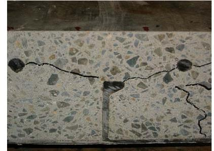
図-1 コンクリート内部の水平ひび割れ
