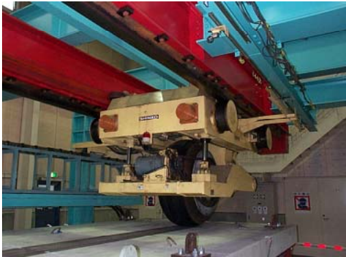
写真－1 荷重載荷試験機
