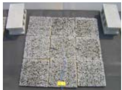
写真-3 供試体 ：ガラス廃材固化材 & 生育繁殖栽培
