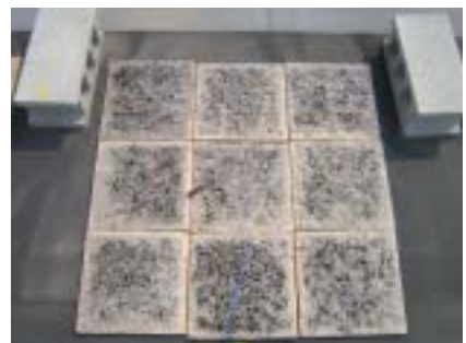
写真-4 供試体 ：マサ土固化材 & 生育繁殖栽培
