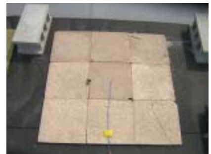
写真-1 供試体：マサ土固化材
