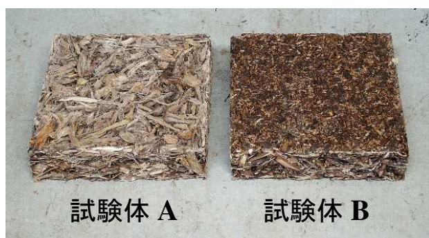
図 1. 試作した多孔質ブロックの外観
