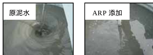
写真2 フロック形成状況(混合反応槽)
