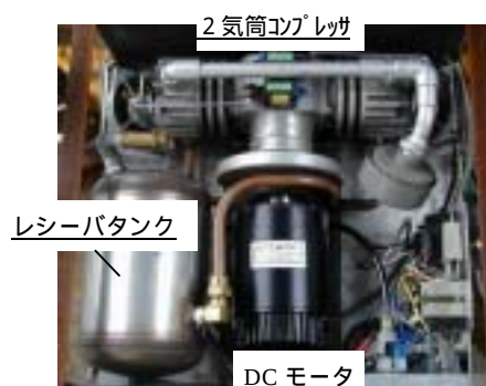
写真-2 駆動部及びコンプレッサ
