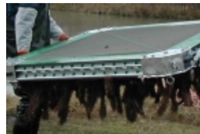
図-3 紐状接触材付き浮島
