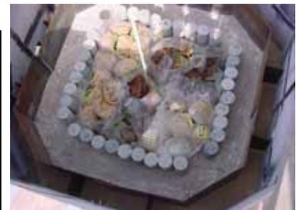
図 - 2 埋設農薬仕込み状況
