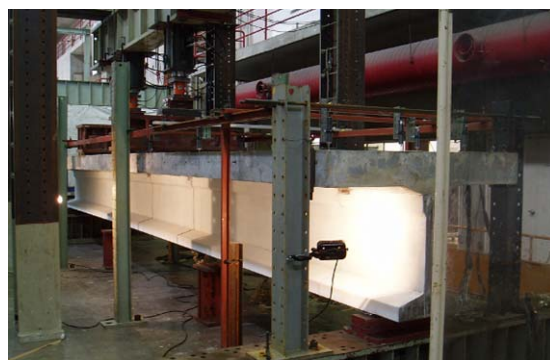
写真-1 実物大モデル載荷実験
