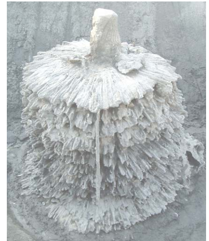
図-4 改良体全景
