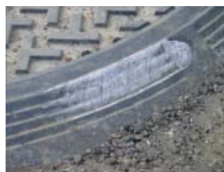
写真－5 衝撃試験後の状況
