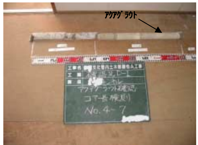
写真-3 アクアグラウト充填確認
