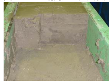
図-9 コンクリートブロック周辺の充填状況
