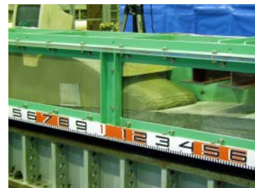
図-3 試験装置内の注入状況
