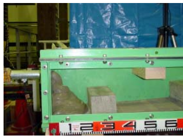
図-2 試験装置内の注入状況
