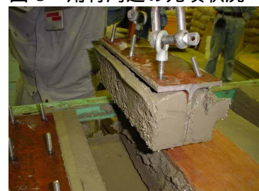
図-7 H型鋼周辺の注入状況
