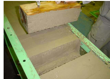
図-5 角材周辺の充填状況
