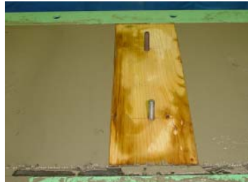
図-4 角材周辺の充填状況
