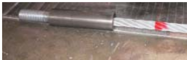
写真-2 引張強度試験供試
