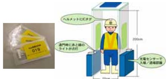
図-1 IC タグの利用事例
