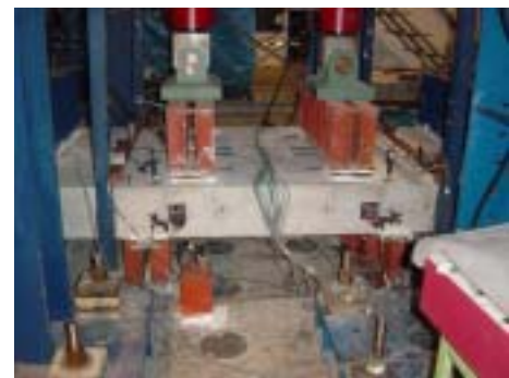
写真-1 継手面外せん断試験装置
