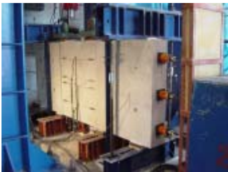
写真-3 継手面内せん断試験装置
