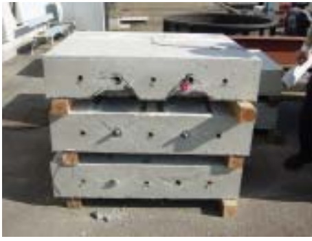
写真-2 破壊後の供試体
