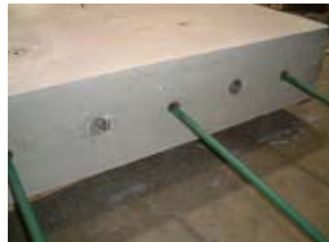
写真-4 破壊後の供試体
