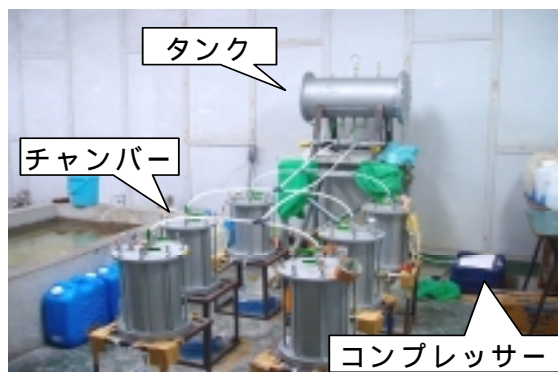
写真 1 漏水実験装置
