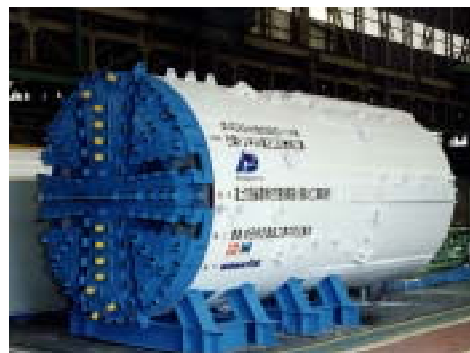
写真-2 シールドマシン
