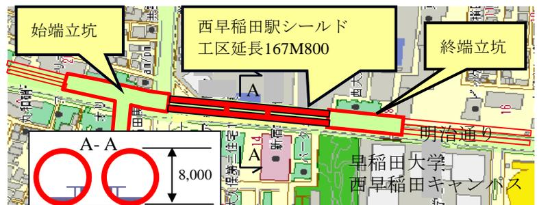
図-1 路線平面図およびトンネル断面図
