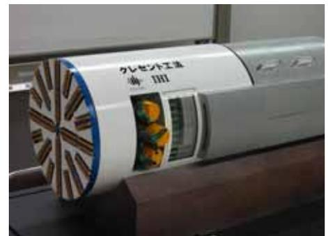
写真-1 クレセント用シールド模型
