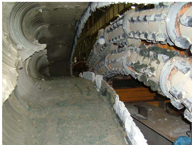
写真-3 模擬地盤掘削後の状況
