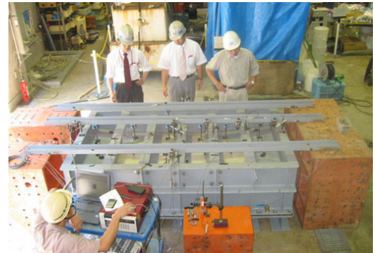
写真－1 外水圧作用時止水実験状況
