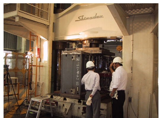
写真－2 推力作用時止水実験状況
