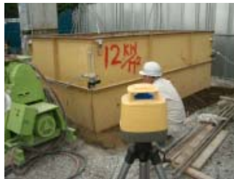
写真 1 10m 3 水槽を用いた沈下修正注入試験状況
