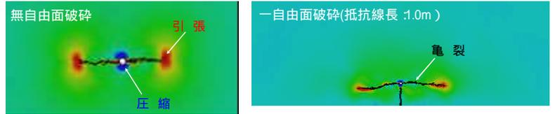
図4 解析結果例（亀裂伸長形態）
