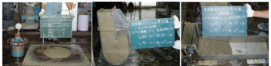
写真1 フレッシュコンクリートの試験状況
