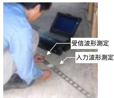
写真2 弾性波速度測定状況
