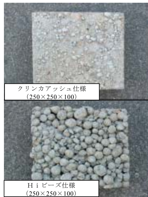
写真-1 コンクリート試験体
