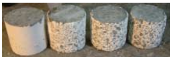
↑ 1週 2週 3週 4週 写真2 コンクリート供試体の経時劣化
