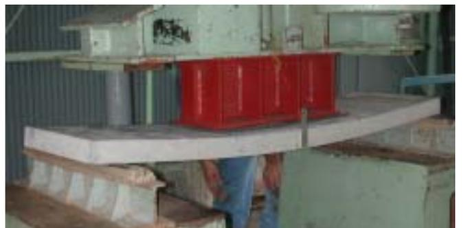
写真-2 スラブの曲げ耐力試験状況
