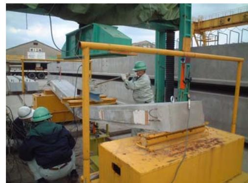
写真-3 はり載荷試験状況
