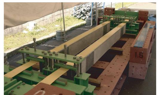
写真-1 緊張接着後の養生状況
