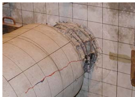
写真 2 終局時の損傷状態 (Case6)
