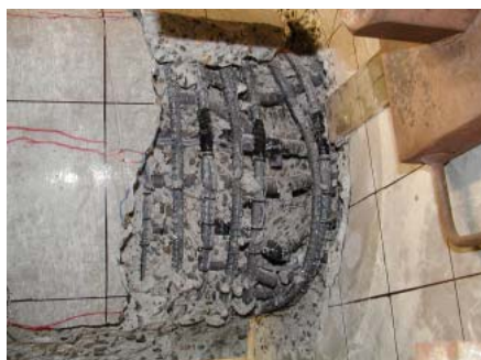
写真 1 終局時の損傷状態 (Case5)
