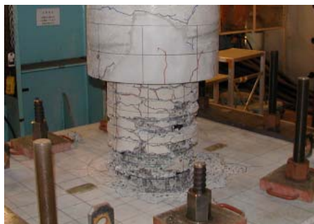
写真 3 終局時の損傷状態 (Case7)
