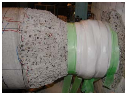
写真 4 終局時の損傷状態 (Case8)
