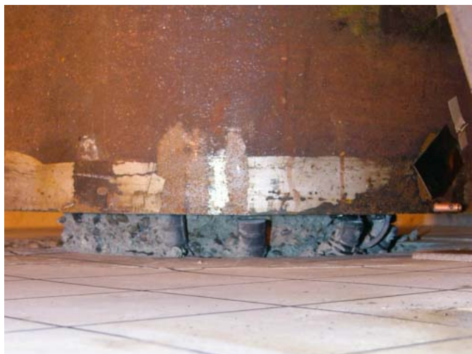
写真2 終局時の損傷状態（SC 杭）
