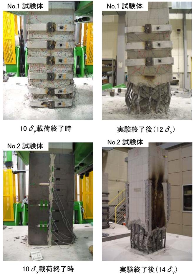
写真-1 試験体損傷状況
