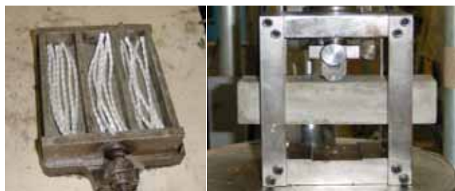
写真-5 ビニール紐と供試体 写真-6 曲げ強度試験
