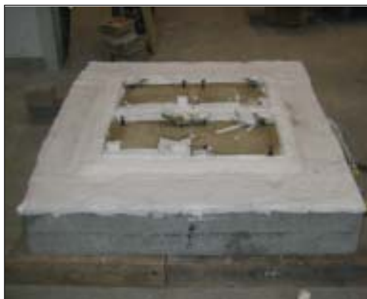
写真—2 耐火試験後
