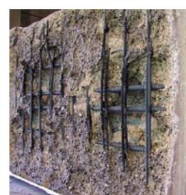
図 3.加熱後の無被覆試験体
