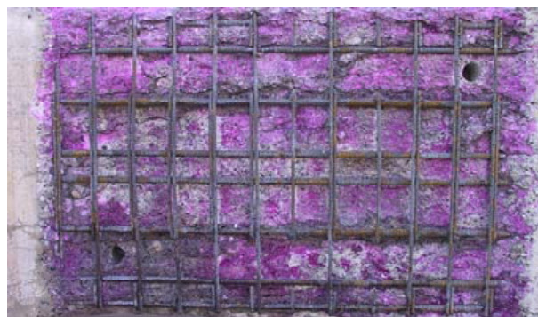
図 8.フェノールフタレインによる除去部分の確認
