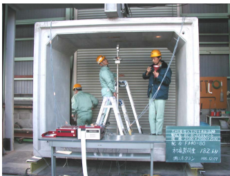
写真－1 外圧試験状況
